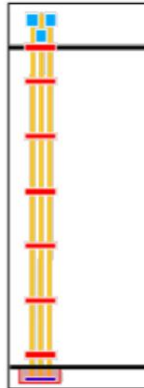
Pojedynczy most na całej długości z możliwością Montażu przekładników
